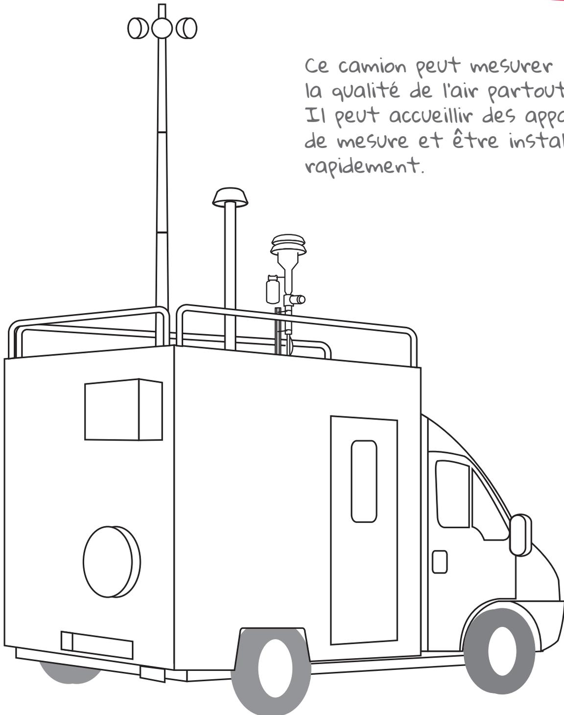
Ce camion peut mesurer la qualité de l'air partout. Il peut accueillir des appareils de mesure et être installé rapidement.
