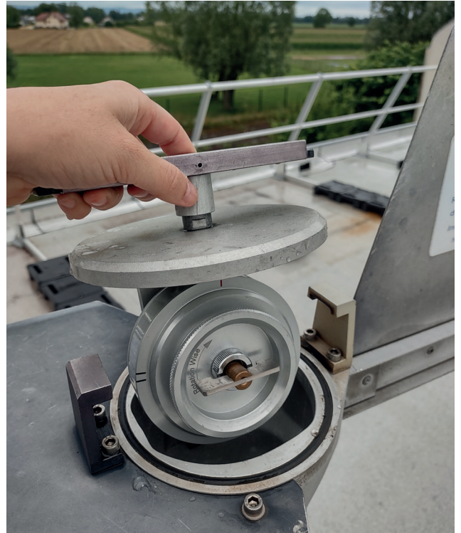
Installation du premier prélèvement 2023 dans le capteur de Bletterans © Atmo BFC
