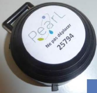
Dosimètre pour la mesure du radon
