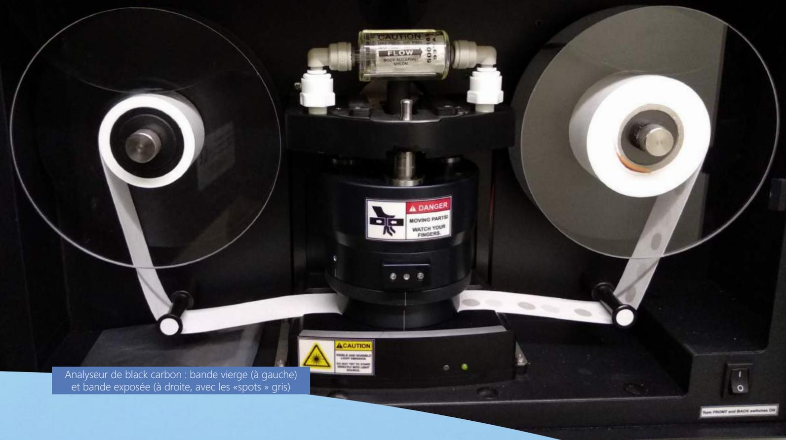
Analyseur de black carbon : bande vierge (à gauche) et bande exposée (à droite, avec les «spots » gris)
