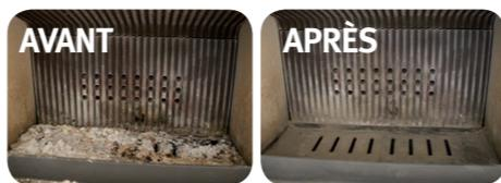
**Pour des appareils fonctionnant aux granulés :** dépoussiérer le pot de combustion à l'aide d'un aspirateur à cendres. Si cela ne suffit pas, utilisez une brosse pour gratter et enlever complètement les résidus
