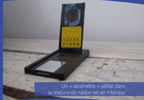
Un « dosimètre » utilisé dans la mesure du radon en air intérieur
